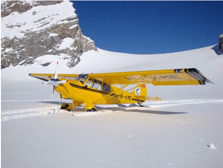
Unser neues Schulflugzeug HB-KME 180 PS mit 4 Blatt Verstell Propeller und neuen Skiern
